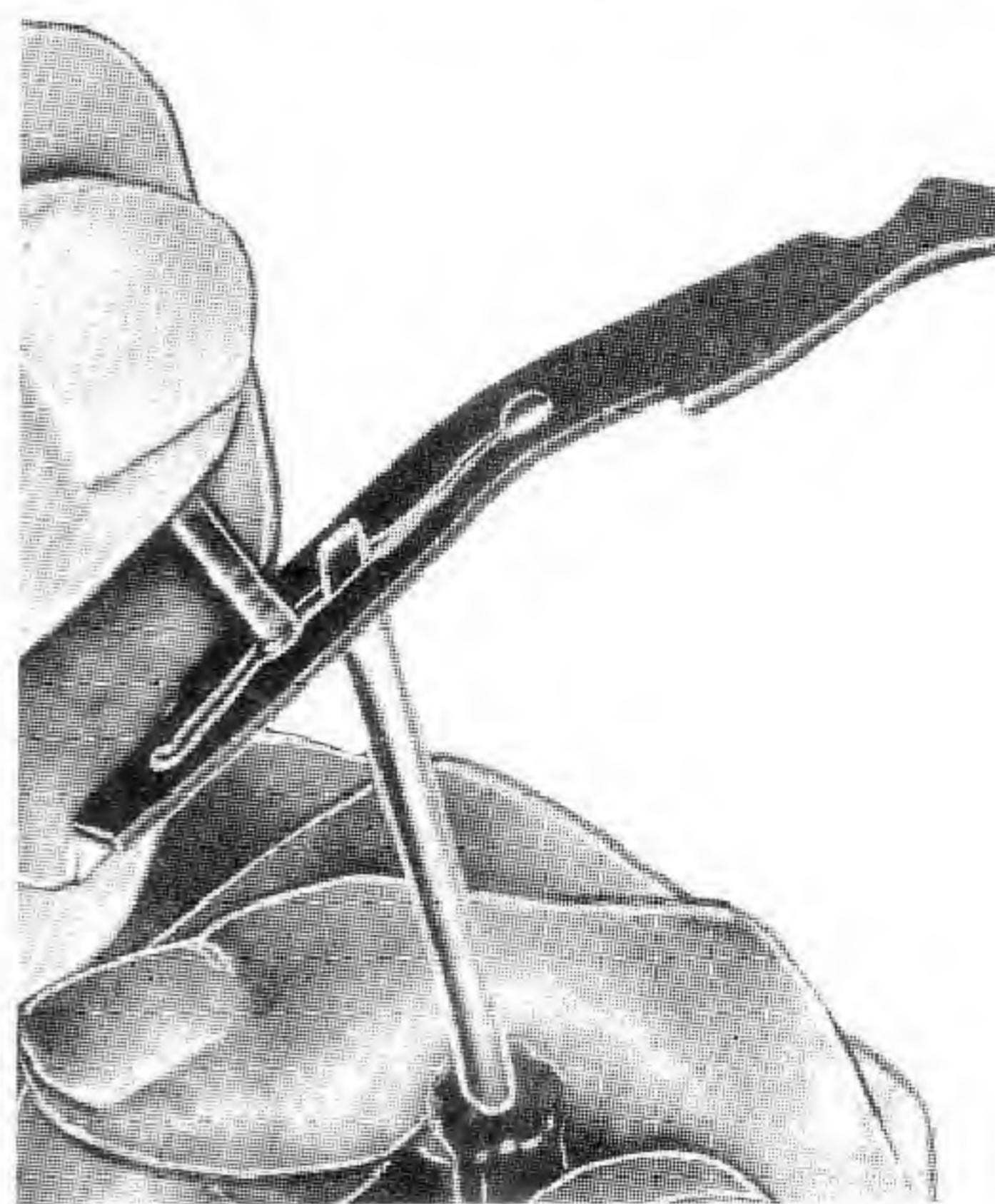
Sl. 88 – Odvajanje osovine delova za okidanje od poluge automatske paljbe
